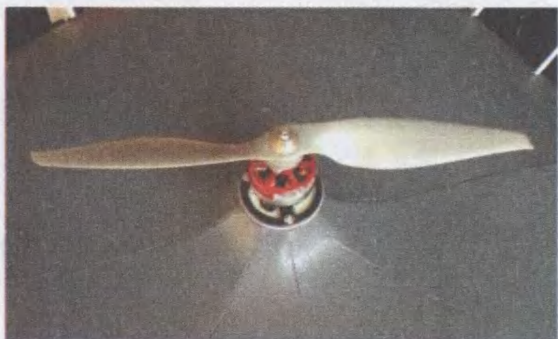
На вершине купола аппарата электромотор с пропеллером.
